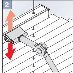
Die Plisseetypen VS7 und VS8 sind für Senkrechtfenster mit einer oder zwei Schrägen geeignet. Solche Fenster sind oftmals beispielsweise an Giebfenstern zu finden. Die Plissees können von oben nach unten geöffnet werden. Die Montage kann entweder im Falz vor dem Glas oder am Fensterflügel mit Hilfe von Winkeln erfolgen.
