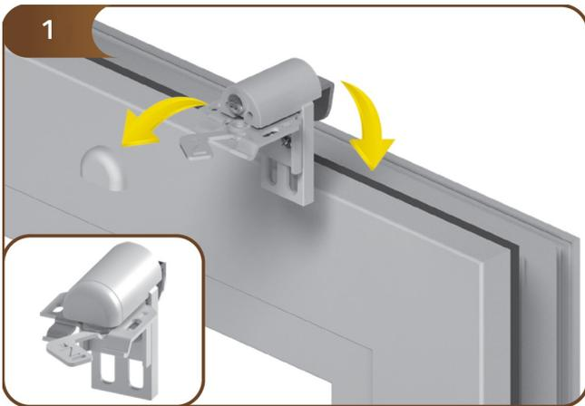
2) Durch Anziehen der Schraube, Klemmträger verspannen:
