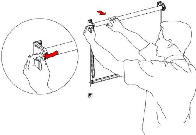
Eine der beliebtesten Montagevarianten für freihängende Rollos ist die Befestigung mit kleinen Schrauben. Dabei wird das Rollo entweder an der Wand oder an der Decke angebracht. Die Montageträger werden sicher verschraubt und das Rollo wird an ihnen montiert. Seitliche Spannschnüre verleihen dem [Rollo](#) auf Wunsch zusätzliche Stabilität. Sie sorgen dafür, dass das Rollo auch bei gekipptem Fenster in seiner Position bleibt. Mithilfe einer Kugelkette kann es mühelos bedient werden.
