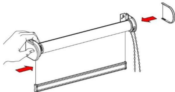
5.) Einsetzen des Kugelkettenverbinders
