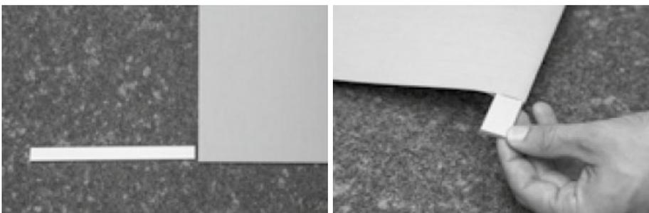
5b.) Schieben Sie den gefalzten Stoff seitlich in das Designprofil und verschrauben Sie anschließend dessen Endkappe.
